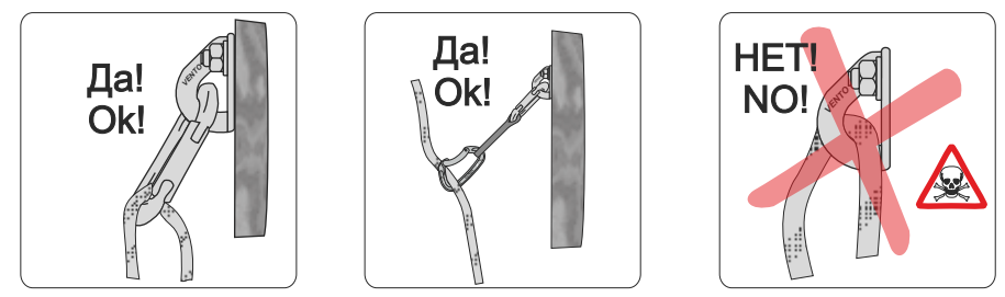
(RU) Установка и использование анкерного устройства с кольцом и цепью (EN) Installation and using anchor with rappel ring and chain
