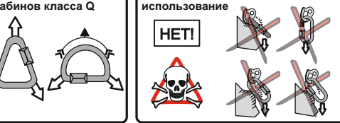
Рис. 8. Приложение нагрузки для карабинов класса Q
