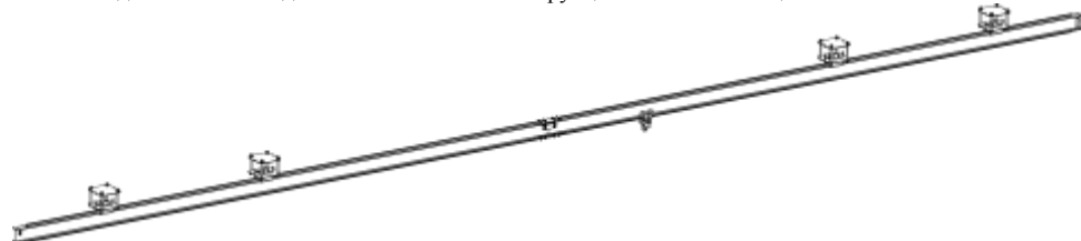
Общая схема анкерной системы VENTO «ДВУТАВР»
